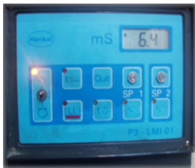
Slika 18: Instrument za nadzor procesne raztopine ter naprava za avtomatsko doziranje razmastilno-fosfatirnega sredstva.
