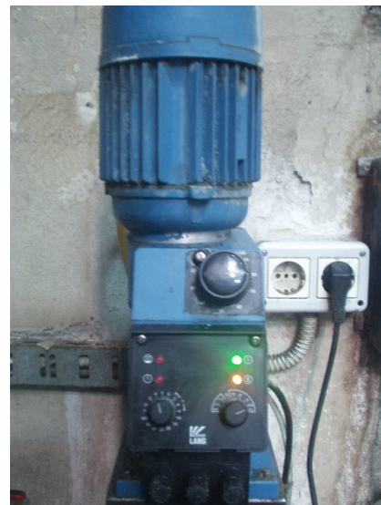
Slika 18: Instrument za nadzor procesne raztopine ter naprava za avtomatsko doziranje razmastilno-fosfatirnega sredstva.
